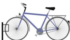
Reine Vorderradhalter sollen heutzutage nicht mehr verwendet werden. Bei dieser Form der Abstellanlage wird nur das Vorderrad eingeklemmt, die Felge muss also das gesamte Gewicht des Rades halten, wodurch eine Beschädigung des Vorderrades nicht ausgeschlossen werden kann.
