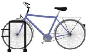
Gabelhalter verhindern eine Beschädigung des Vorderrades, indem die Gabel und je nach Rahmengenometrie auch ein Teil des Rahmens angelehnt werden können. Teilweise sind noch zusätzliche Elemente angebracht, die ein Wegrutschen des Vorderrades verhindern („Focussystem“ beim Modell Beta der Fa. Orion).
