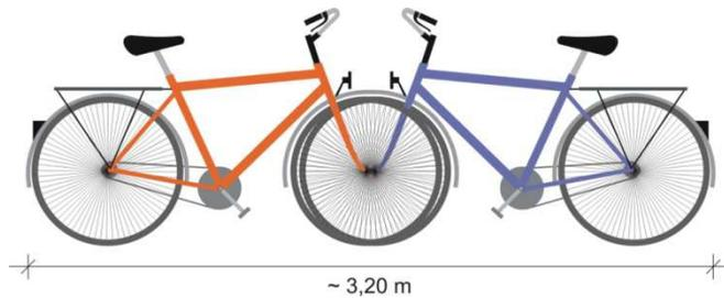
Wird die Tiefeinstellung beidseitig ausgeführt, kann der notwendige Raum pro Rad aufgrund sich überlappender Vorderräder verringert werden. Je mehr Stellplätze ausgeführt werden, desto größeren Einfluss hat diese Raumersparnis, so dass der Raumbedarf pro Rad ungefähr in einer Spanne von 1,1 bis 1,3 m<sup>2</sup> liegt.
