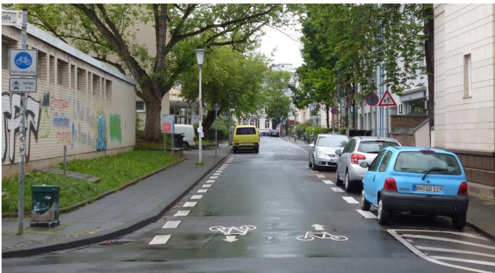
Schmale Fahrbahnen ohne Parken am Fahrbahnrand sollten entlang der Bordsteine eine unterbrochene Breitstrichmarkierung und mittig in regelmäßigen Abständen (ca. 50 m) Fahrradpiktogramme erhalten. Breitere Fahrbahnen mit einseitigem Parken am Fahrbahnrand erhalten Fahrgassen in einer Breite von 3,00 bis 4,50 m.
