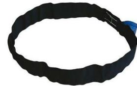
Aufgrund ihrer Materialeigenschaften dürfen Rundschnlingen aus synthetischen Fasern für Lasten über Personen nur in Verbindung mit einer ausreichend dimensionierten metallischen Sekundärsicherung eingesetzt werden. Rundschnlingen mit Stahleinlage benötigen keine gesonderte Sekundärsicherung.
